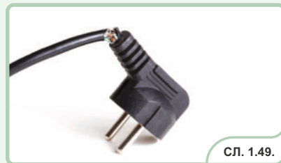
ОШТЕЋЕН КАБЛ: ЗАБРАЊЕНА УПОТРЕБА ДО ПОПРАВКЕ
