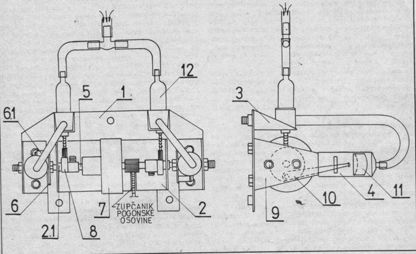
nje ne dozvoljava pa smo se odlučili za razdvojuvu vezu vijcima i navrtkama. Veliki broj obrtaja motora zahteva stabilnost ležišta i držača ventila što je dovelo do novih konstruktivnih rešenja ovih elemenata.
