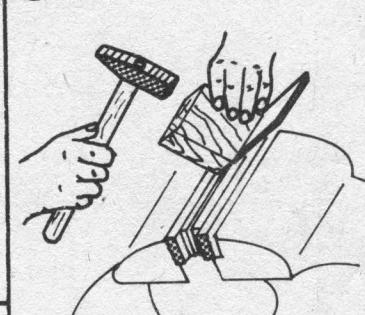
7. Pozicije 2, 3 i 4 savij na označenim mestima (isprekidana linija) prema priloženim crtežima. Čekićem ne udaraj direktno po limu jer ćeš ošteti površinu.
